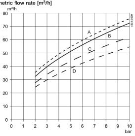
A) 2 x ø21 mm Nozzles B) 2 x ø19 mm C) 2 x ø17 mm D) 2 x ø15 mm
